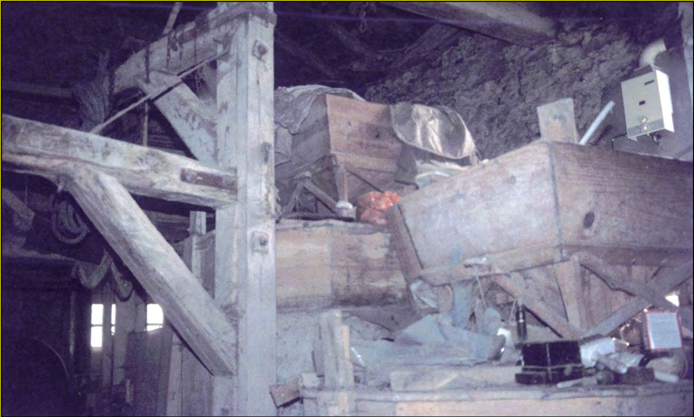
Errotaren barrualdea, errotarria eta gurpila elikatzen zituen tobera ikus daiteke.
