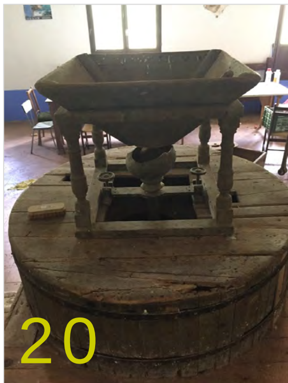
20. argazkia. Ur-errota baten elikadura-tobera. Elementu horiek berreskuratzeak eta birgaitzeak lehen mailako balioa eman diezaieke haur eta gazteei, arbasoen historiari eta bizimoduari.
